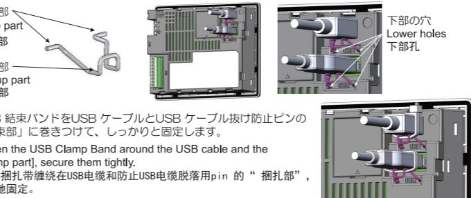
3. USB 結束バンドをUSB ケーブルとUSB ケーブル抜け防止ピンの「結束部」に巻きつけて、しっかりと固定します。
